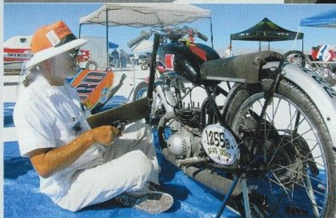
Après les run, le démontage. Le contrôleur du SCTA, Bruce, vérifie la cylindrée de Saline Madame. Plus facile que sur un quatre-cylindres double-arbre ! Ci-dessus, après la casse de Saline Warrior, il ne restait plus qu'à sortir la réplique radioguidée de la Reliant pour amuser la galerie !
