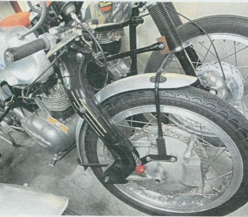
Cette NSU Sportmax est une ex-John Surtees, elle est donc moitié anglaise... Biellettes de fourche et frein spécifiques distinguant au premier coup d'œil une Sportmax d'un modèle série coursifié.
