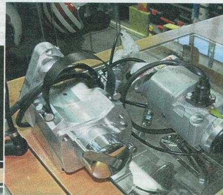
Nouveaux produits de BTH, des magnétos entièrement électroniques. Extérieurement on jurerait une Lucas Racing : c'est une magnéto entièrement électronique ! Magdyno Lucas ? Contrairement aux apparences, c'est une magnéto entièrement électronique faite pour recevoir une dynamo conventionnelle ou un Alton.
